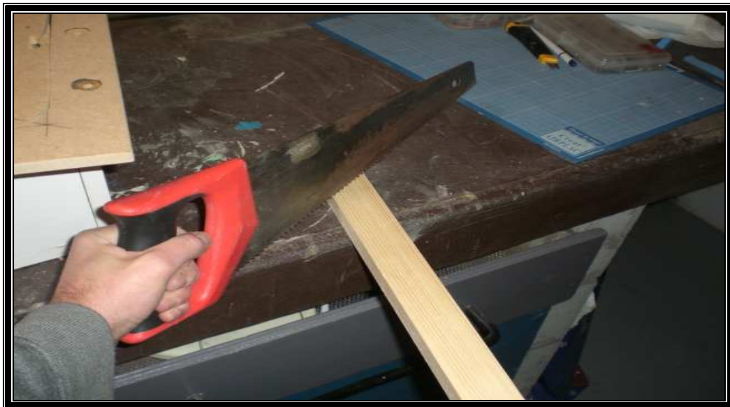
Découpe de l'autre partie du cadre dans du tasseau de 40mm de large, cadre qui sera renforcé d'équerres métalliques.
