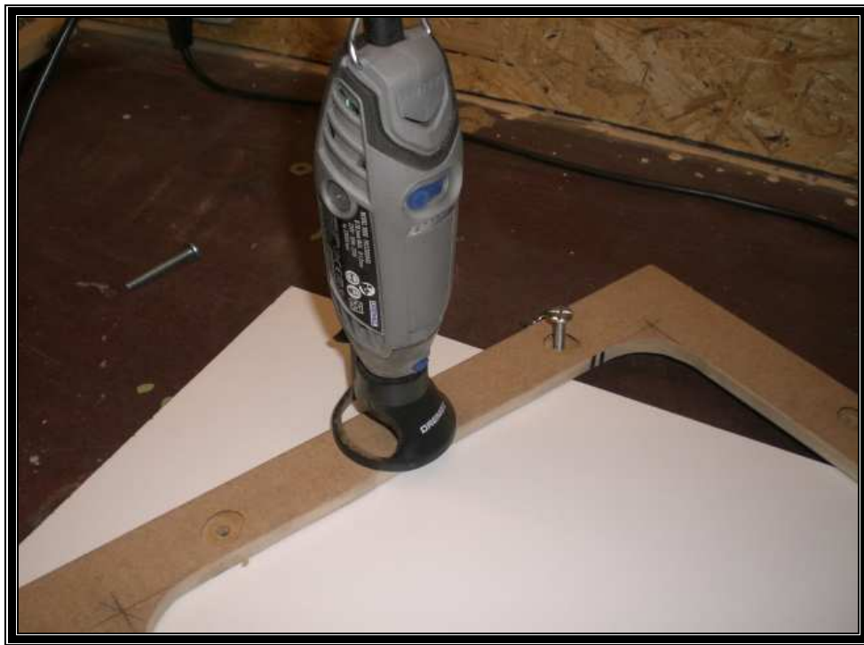
Fraisage des trous pour vis M6, les trous sont espacés de 150mm sur la longueur et de 100mm sur la largeur.
